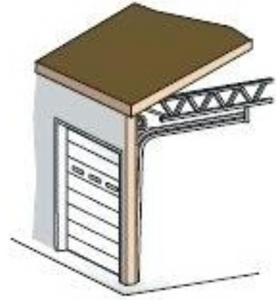
Tharik Mekanizması Önde Lifting System in the Front
